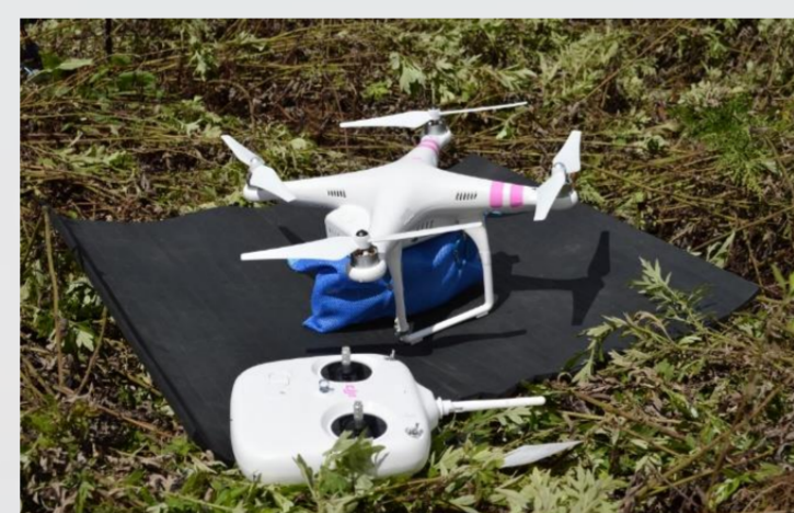
無線システムのUAV(Phantom2)への搭載
