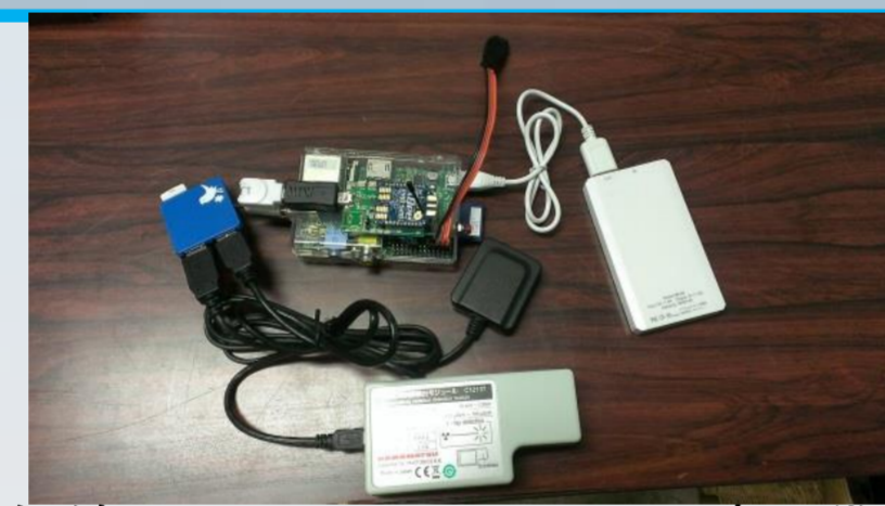
無線システム(Phantom2下の青い袋内に格納)→軽量となり小型UAVへの搭載が可能になった
